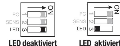
Zusatzinfo: Bei Registrierung an einer Galaxy oder Vista blinkt die LED bei Alarm zweimal.
